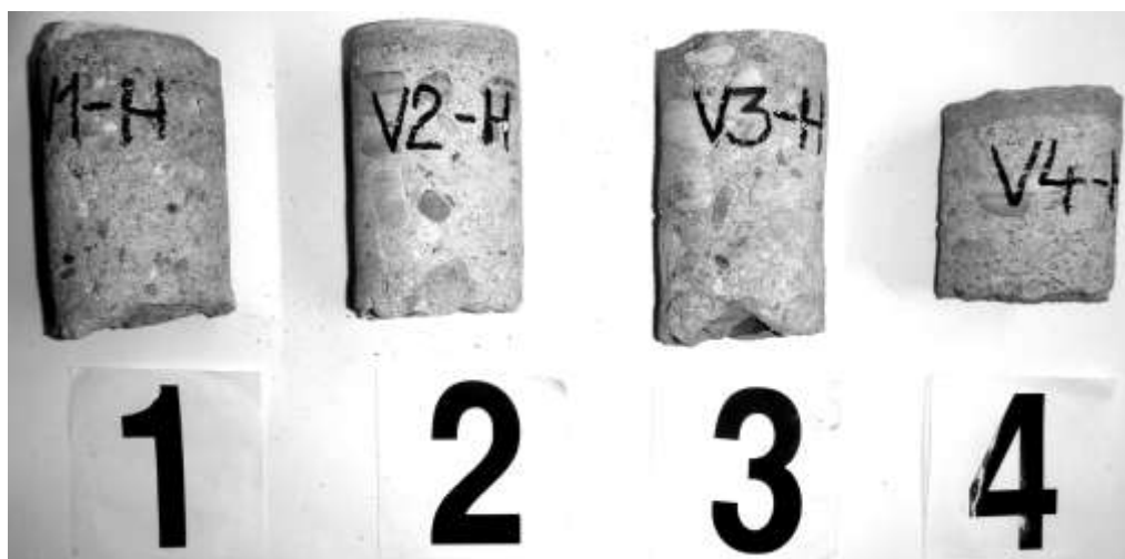
Foto č.3.1: Dokumentace vývrtů pro destruktivní zkoušky pevnosti v tlaku betonu
